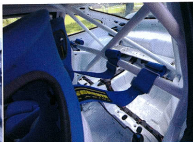
La coque de GT3 R possède un véritable arceau cage soudé d'origine
