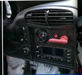
Le coupe-circuit et la jauge du régime supplémentaire ont remplacé l'autoradio
