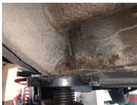
Corrosion soubassement longeron ARG
